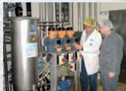
Die CIP-Anlage auf dem Bild verfügt über eine automatische Dosierung. Zugunsten der Umwelt- und Abwasserbilanz wird jeweils nur die für den aktuellen Gebrauch notwendige Menge an Reinigungsmitteln aufbereitet und zur Verfügung gestellt. Hanspeter Broder (links) im Gespräch mit einem Mitarbeitenden von Thurella AG in Egnach.
